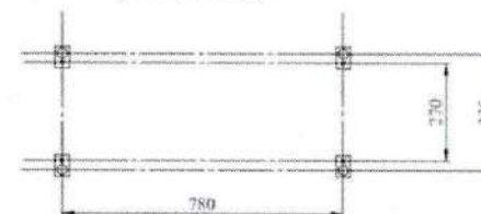
Scheme of the post placing with foundations (Схема расположения фундаментов со стойками)
